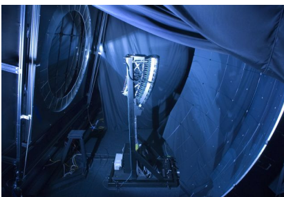
Abb. 3: Blick in das Innere eines Teleskopgebäudes. Links oben sind das Eintrittsfenster und eine ringförmige Korrekturlinse zu sehen. Das Licht fällt auf den 11 Quadratmeter großen segmentierten Spiegel und wird dann auf die Kamera mit 440 Lichtsensoren reflektiert
