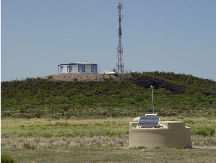
Abb. 1: Teilchendetektor in der Pampa: ein Tank von 12 Kubikmetern Reinstwasser ist mit Lichtsensoren ausgestattet, die das schwache so genannte Cherenkovlicht registrieren, das energiereiche Teilchen beim Durchqueren des Wassers aussenden. Jeder Tank arbeitet autonom mit Solarstromversorgung (ca. 10W), GPS-Empfänger zur Zeitsynchronisation und Datenfunk zur Zentralstation. Im Hintergrund ist das Teleskopgebäude „LEONES“ zu sehen, in dem 6 der in Abb. 3 gezeigten Teleskope untergebracht sind.
