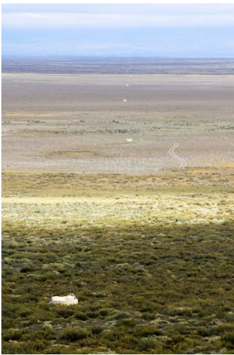
Abb. 2: Das Netz der Teilchendetektoren ist aus Kostengründen mit 1,5 km Abstand grobmaschig ausgelegt. Das Bild zeigt mehrere der in Abb. 1 gezeigten Wassertanks.
